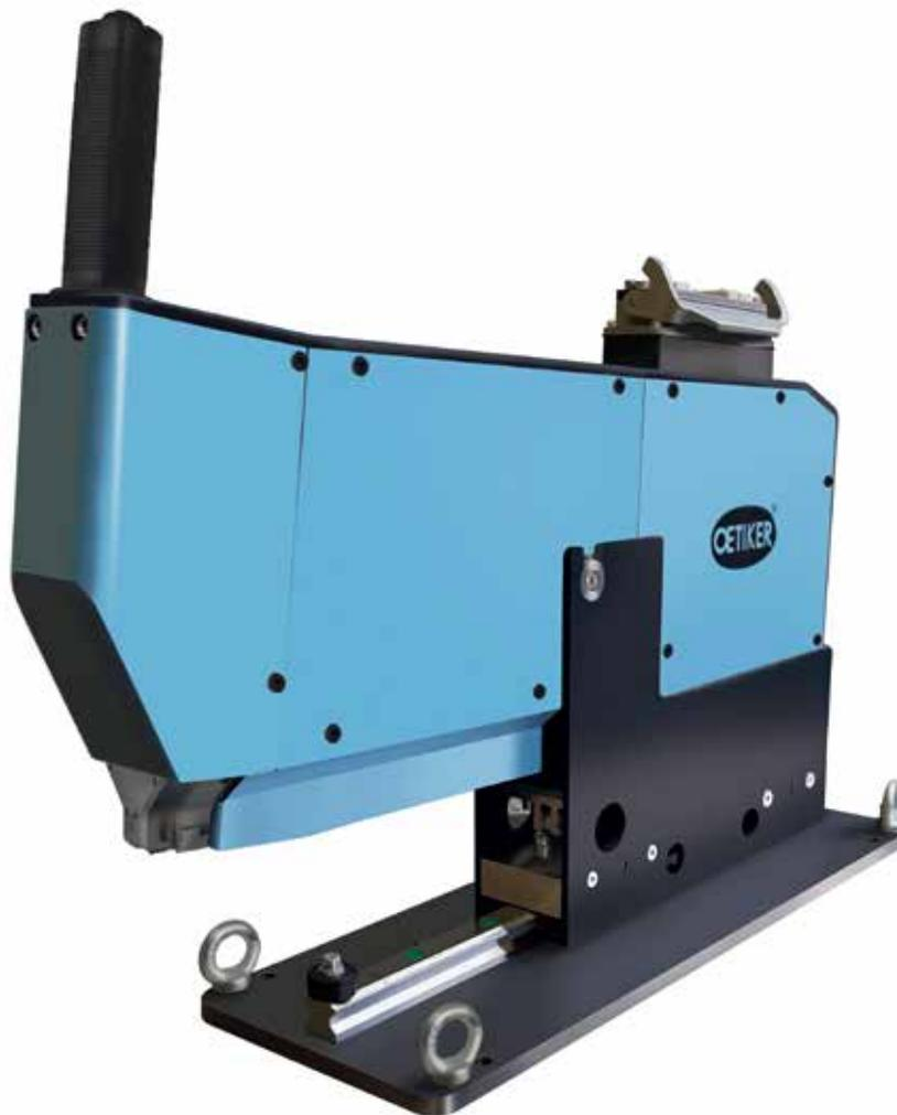
**Proceso de montaje rápido:** Tiempo de montaje de 3,5 s para aplicaciones típicas de airbag
