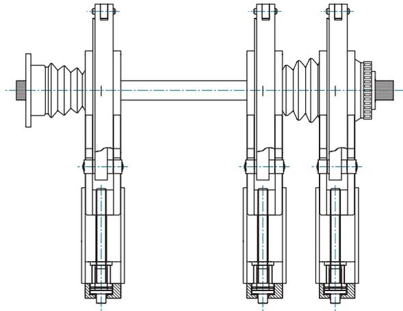
Exemple d'un montage de dispositifs à rétreindre.
