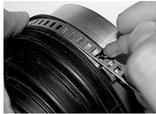
Paso 2 Determinar la longitud de la abrazadera.
