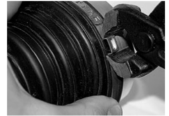
Paso 4 Colocar la abrazadera sobre la pieza. Enganchar el cierre en la posición más ajustada posible. Cerrar la oreja adecuadamente con una tenaza Oetiker
