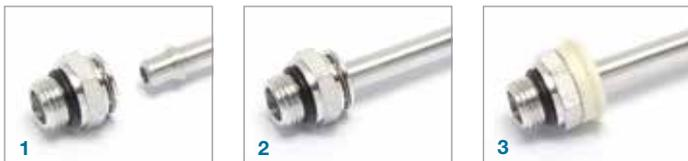
Pour la déconnexion, retirer le capuchon et fixer ou placer l'outil de déconnexion sur le tube avec les doigts face au connecteur. Faire glisser l'outil de déconnexion sur le tube et engager l'anneau de retenue. Tourner l'outil de déconnexion sur 60 degrés pour étendre l'anneau de retenue. En maintenant l'outil de déconnexion contre le connecteur, tirer sur le tube pour le déposer.
